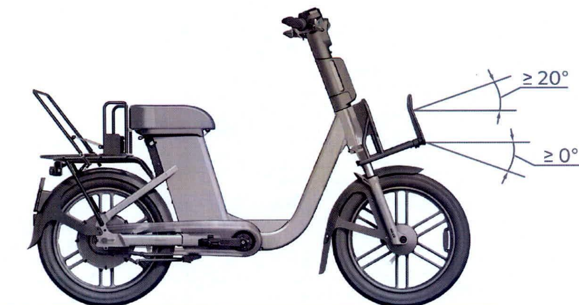
Рисунок 2 – Положение переднего и заднего идентификационных номеров относительно транспортного средства
